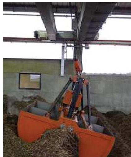
Pro manipulaci je instalován drapák o objemu 6 m 3
