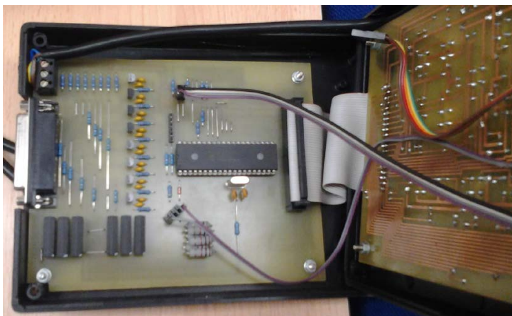
Obr. 1.5 Příklad vnitřního uspořádání řídicího systému s mikrokontrolérem
