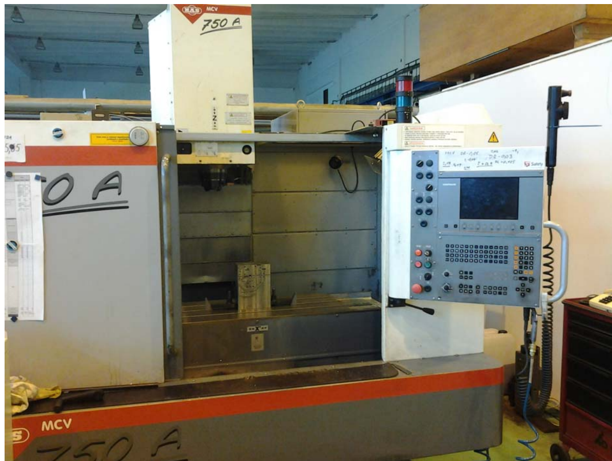
Obr. 1.9 Příklad uspořádání řídicího systému na frézovacím centru
