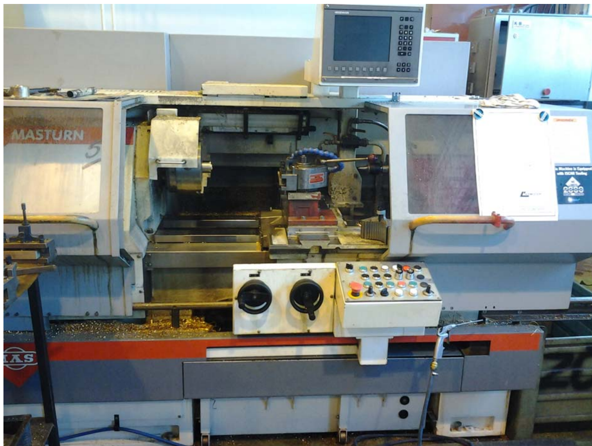
Obr. 1.10 Příklad uspořádání řídicího systému na soustružnickém centru
