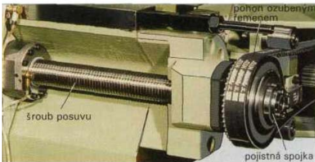
Obr. 1.5 Příklad uspořádání jednotky pro přenos mechanické energie [1]
