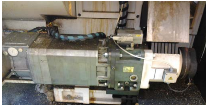
Obr. 1.4 Příklad uspořádání regulační jednotky a pohonného elektromotoru
