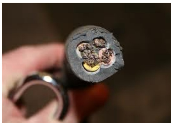
Obr. 1.3-Příklady poškozených vodičů – mechanické poškození se „spálením“; „překousání“ živočichy. [8]
