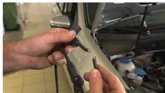
Obr. 1.3-Příklady poškozených vodičů – mechanické poškození se „spálením“; „překousání“ živočichy. [8]
