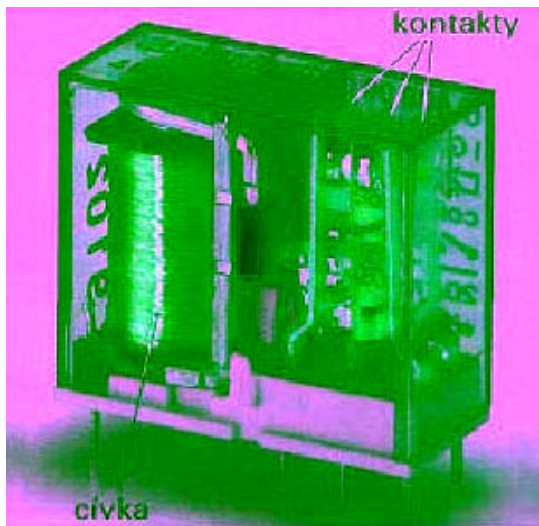
Obr. 1.6 Klasické spínací relé a řez spínacím „jazýčkovým“ relé [1]
