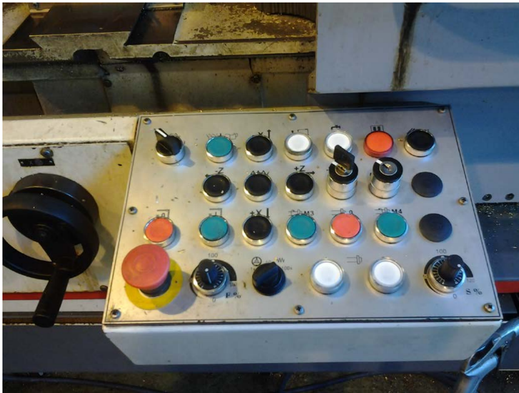
Obr. 1.11-Reální provedení ovládacího panelu s tlačítky a stop tlačítkem u soustružnického centra
