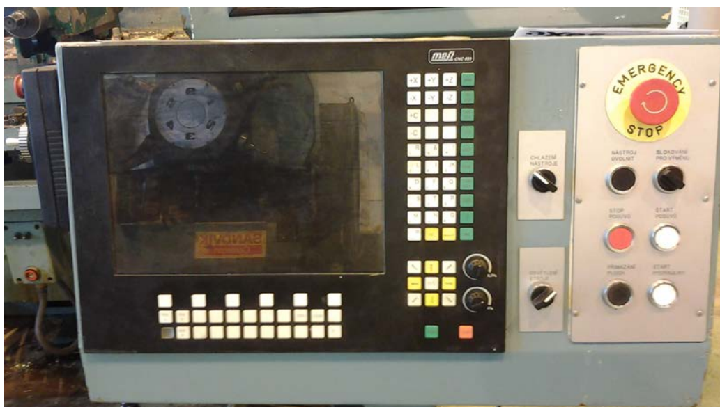
Obr. 1.12-Reální provedení ovládacího panelu s tlačítky, LCD a stop tlačítkem u frézovacího centra
