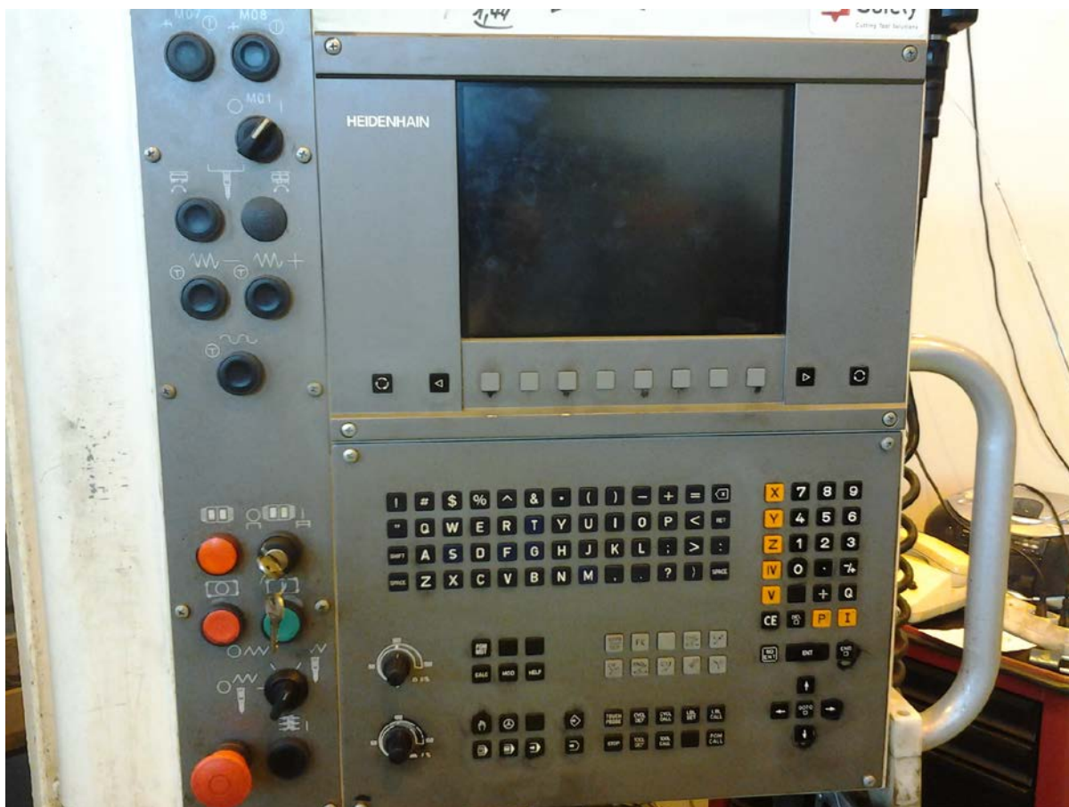
Obr. 1.13-Reální provedení ovládacího panelu s tlačítky, LCD a stop tlačítkem včetně ručního ovládacího panelu u frézovacího centra
