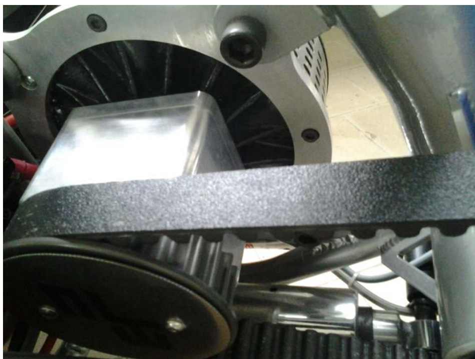
Obr. 1.5 Příklad uspořádání jednotky pohonu - DC elektromotor s ozubeným řemenovým převodem
