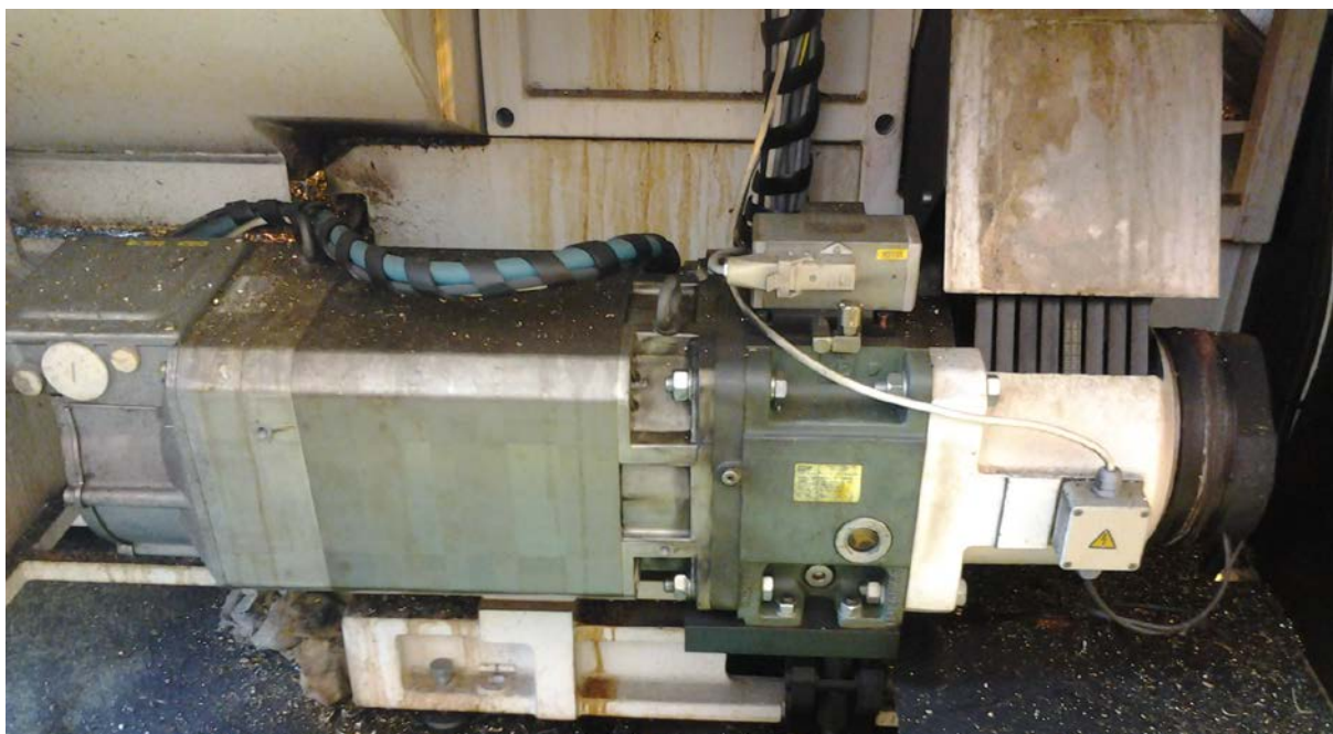
Obr. 1.4 Příklad uspořádání jednotky pohonu - DC elektromotor převodovkou a následným výstupním řemenovým převodem
