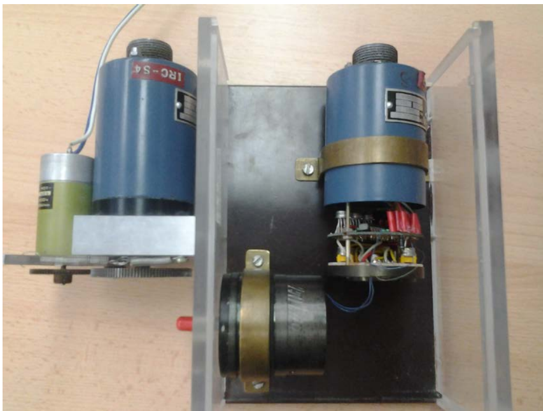
Obr. 1.7 Vnitřní uspořádání IRC snímače
