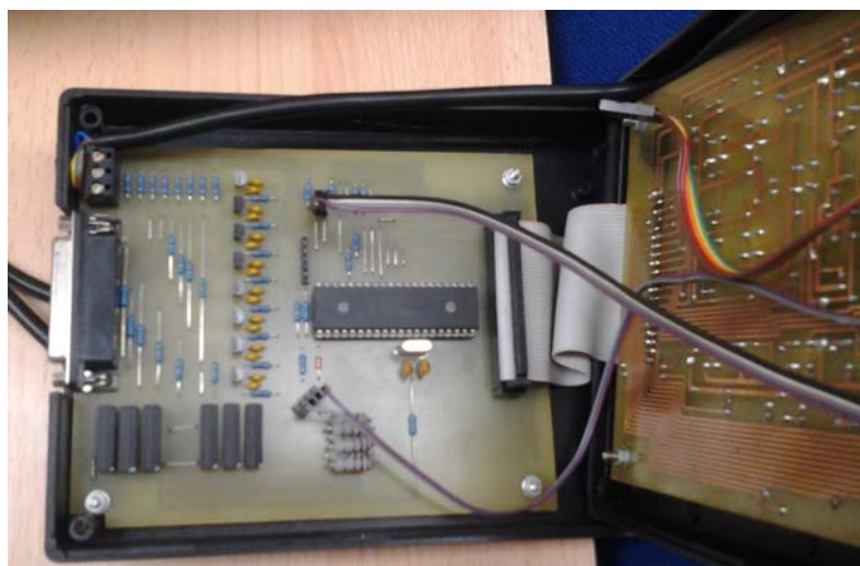
Obr. 1.3 Příklad vnitřního uspořádání řídicího systému s mikrokontrolérem
