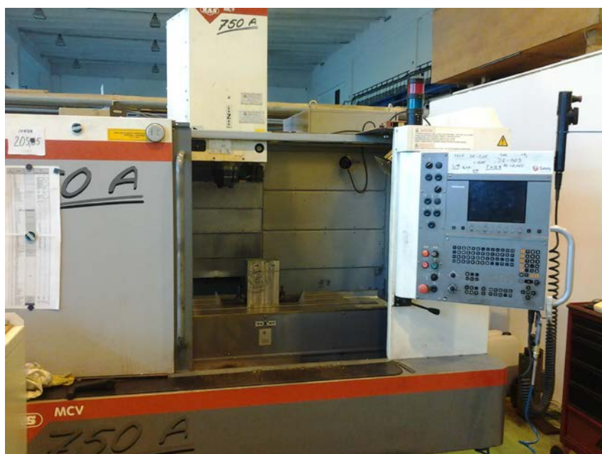
Obr. 3.2 Reálné provedení řídicího systému pro průmyslové frézovací centra
