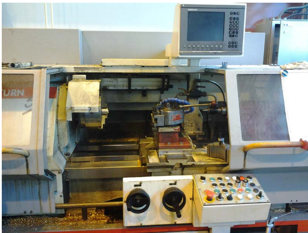
Obr. 3.3 Reálné provedené řídicího systému pro průmyslové soustružnické centra
