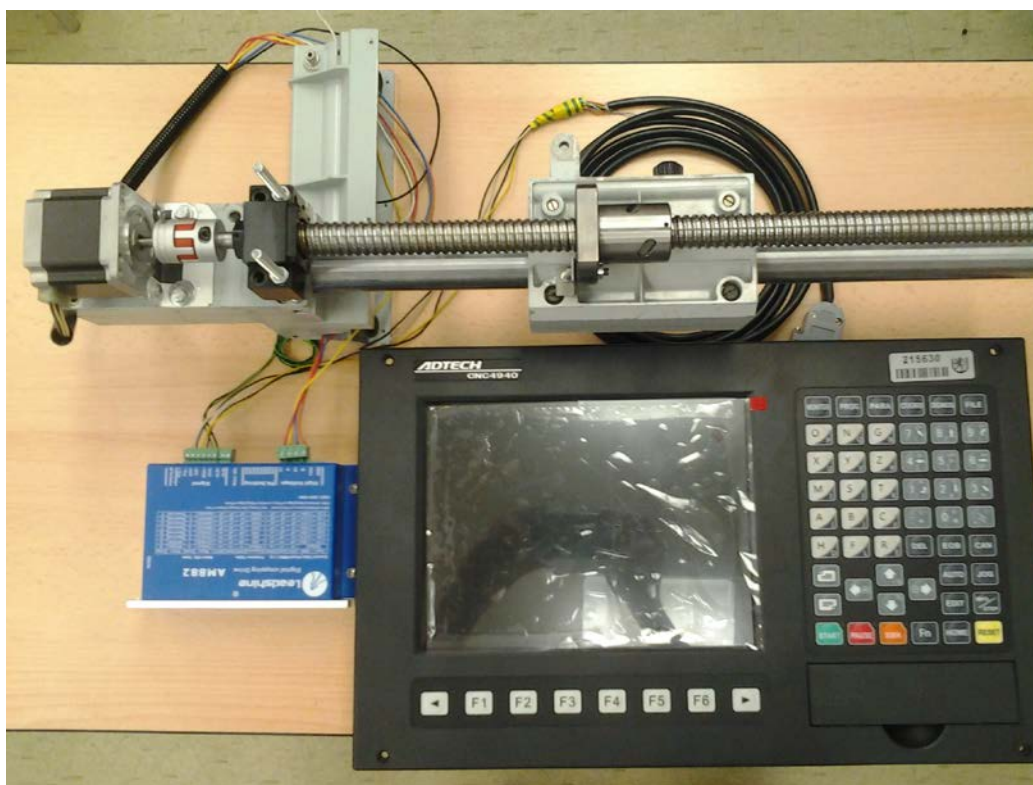
Obr. 2.8 Reálné zapojení CNC řízení, výkonového řízení pohonu krokového motoru se zpětnou vazbou
