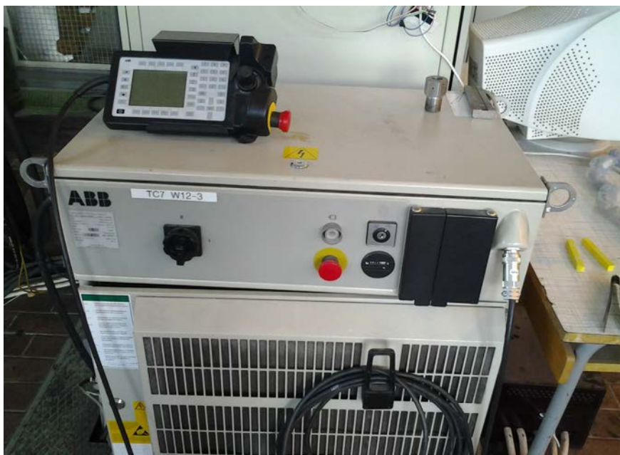
Obr. 3.1 Reálné provedení řídicího systému pro průmyslové roboty
