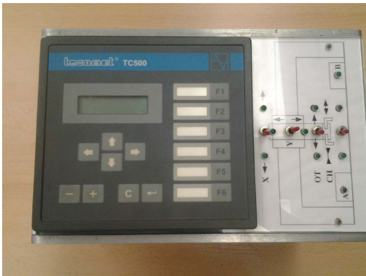
Obr. 2.3 PLC automat s možností ručního binárního (logického) řízení pomocí přepínačů
