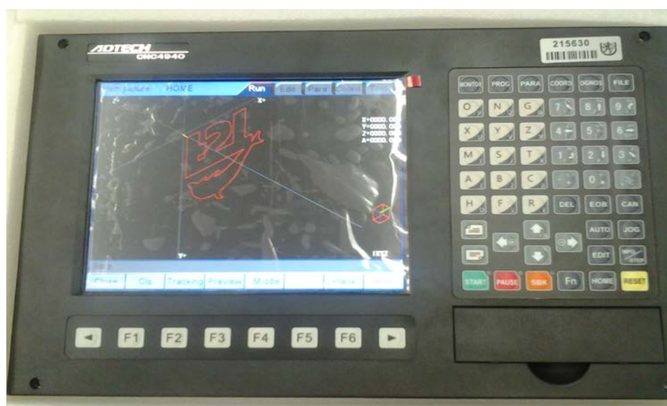
Obr. 3.3 Reálné provedení samostatného řídicího systému pro zakomponování do výrobního stroje
