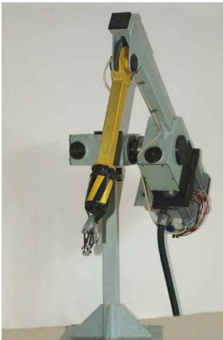
Obr. 5 Příklad manipulátoru - jednoduchého průmyslového robotu
