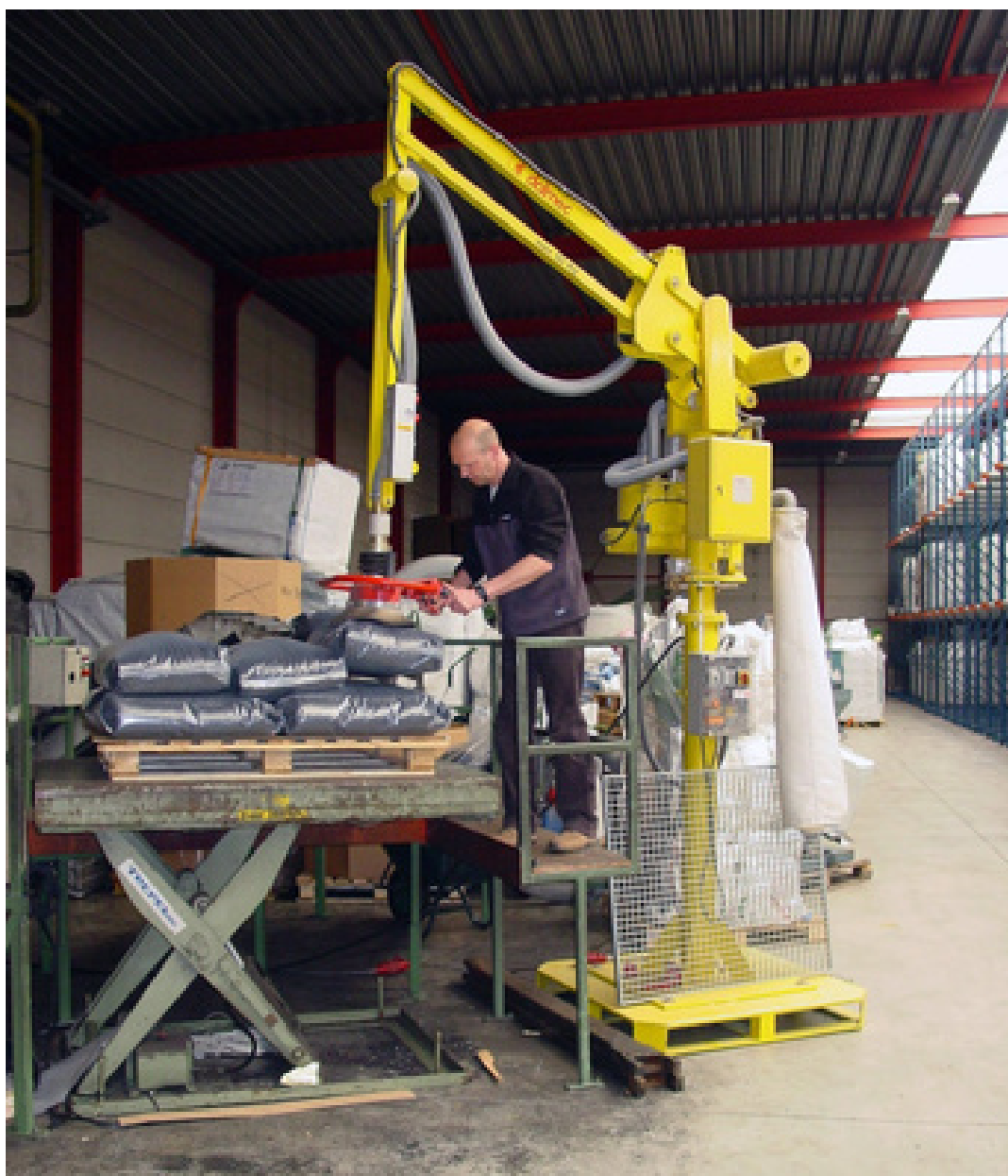
Obr. 4 Pneumaticky poháněný manipulátor (teleoperátor) [12]
