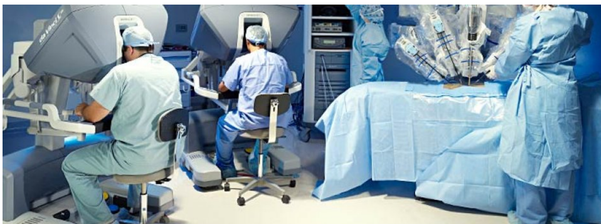
Obr. 3 Teleoperátor ROBOT 350 Da Vinci [11]
