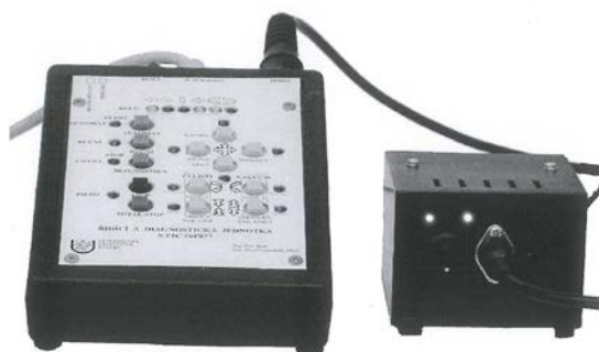
Obr. 1.1 – Samostatný řídicí systém s napájecím zdrojem
