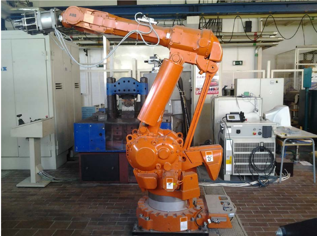
Obr. 1.9 Příklad robota s kinematikou RRR
