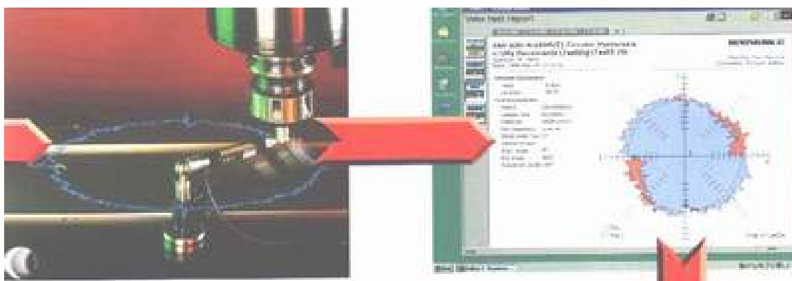
Obr. 1.5. Ukázka měření a diagnostikování stavu stroje [15]
