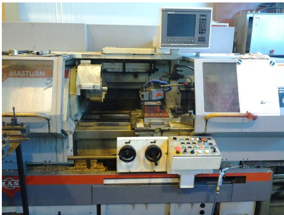
Obr. 13 Zakomponování reálného provedení řídicího systému v průmyslovém soustružnickém centru
