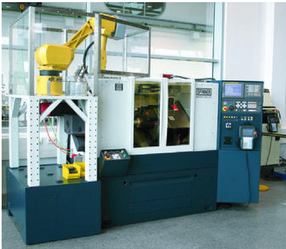
Obr. 12 Příklad komplexního automatizovaného pracoviště řídicími systémy [16]
