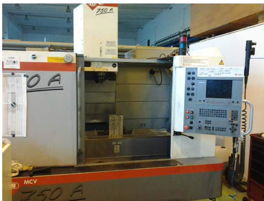
Obr. 14 Zakomponování reálného provedení řídicího systému v průmyslovém frézovacím centru
