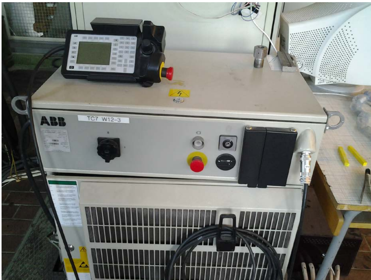
Obr. 10 Příklad řídicí jednotky ABB s připojenou ruční řídicí jednotkou
