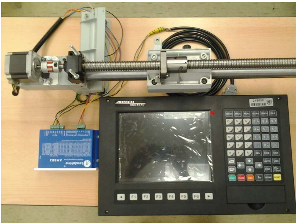
Obr. 2. Reálné propojení: řídicí CNC systém – výkonové řízení KM – KM (krokový motor)
