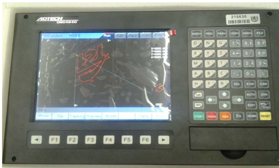
Obr. 16 Reálné provedení samostatného řídicího systému pro průmyslové použití s možností integrace do výrobního stroje
