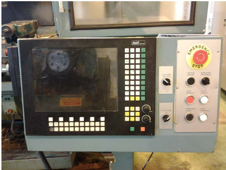
Obr. 15 Zakomponování reálného provedení řídicího systému v základním frézovacím centru
