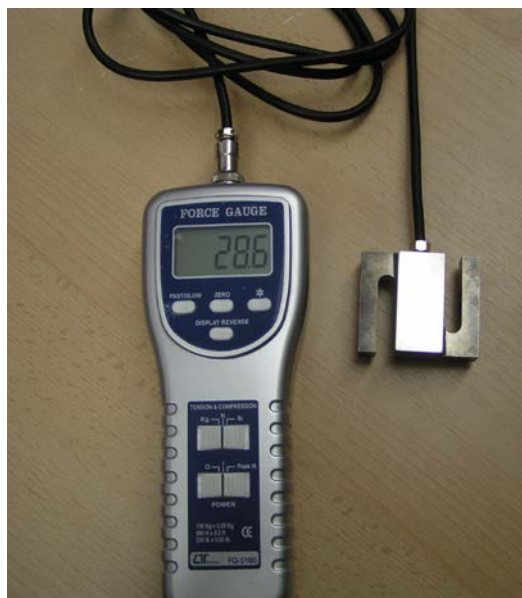
Obr. 12. Popis celkového uspořádání tenzometrického snímače síly
