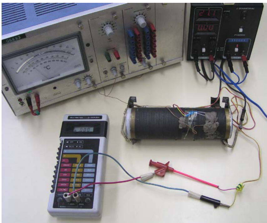
Obr. 4 – Měření charakteristiky termistoru (celkové uspořádání měření)
