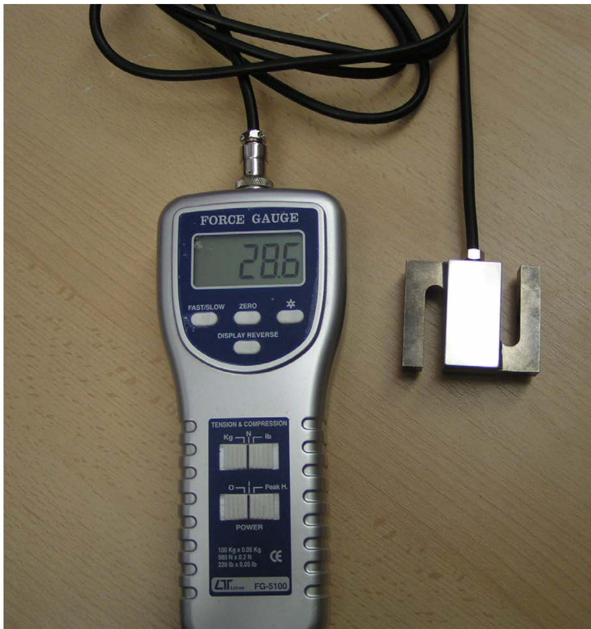
Obr. 3.4 – Měření síly digitálním siloměrem (celkové uspořádání snímače)
