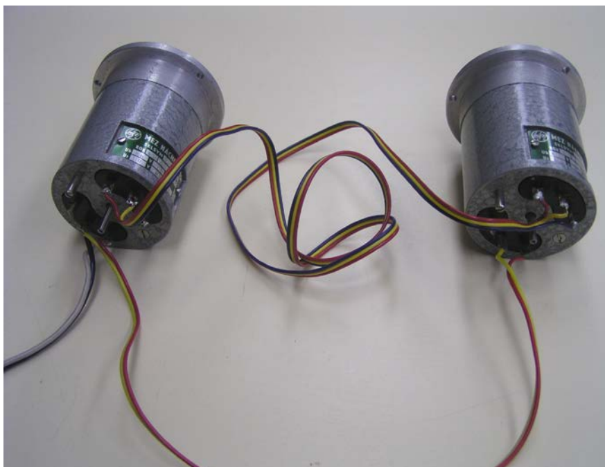
Obr. 6 – Příklad praktického zapojení dvou selsynů
