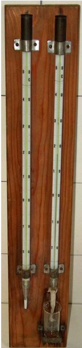
Obr. 1.3 Psychrometr (a- nevětraný; b- uměle větraná tj. aspirační) [3]
