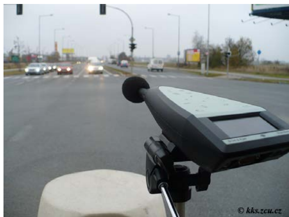
Obr. 1.1 Příklad měření hlukoměrem s analýzou a záznamem dat z měření
