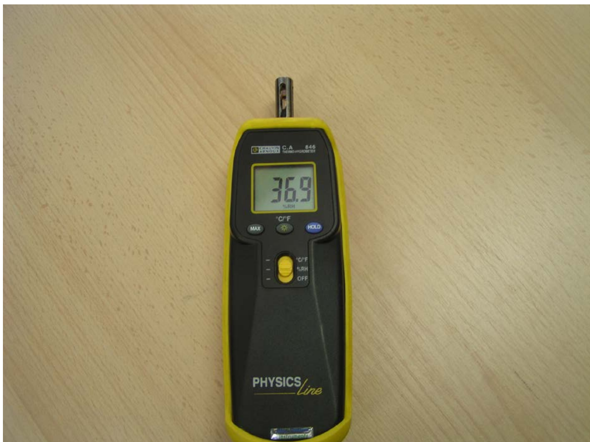
Obr. 1.2 Příklad měření odporovým Hygrometr
