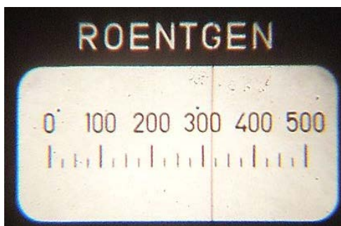
Obr. 1.8 – Stupnice dozimetrického měření radioaktivity v jednotkách Rentgen.
