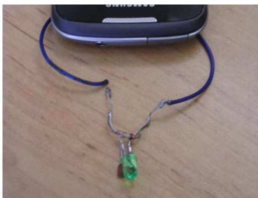
Obr. 1 – Měření VF záření mobilního telefonu (celkové uspořádání měření)
