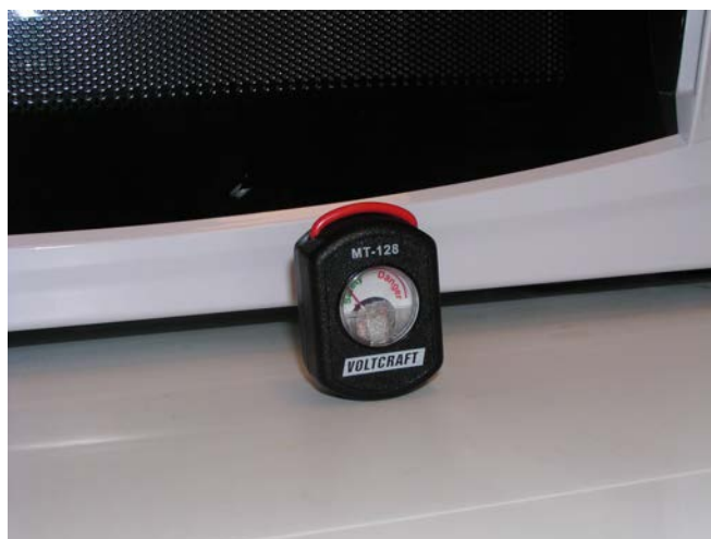
Obr. 1.3 – Měření VF záření mikrovlnné trouby (celkové uspořádání měření)
