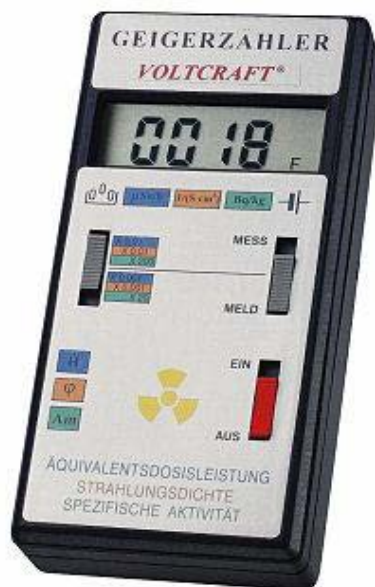
Obr. 2.1 – Digitální přístroj pro měření radioaktivity (ionizujícího záření)
