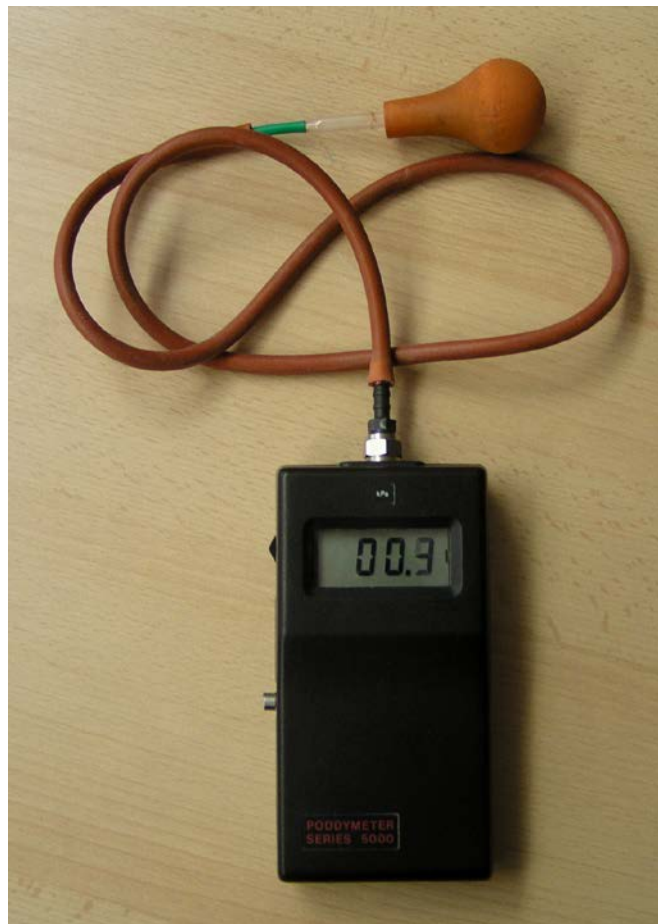
Obr. 2 Měření tlaku (přetlaku i podtlaku) pomocí digitálního tlakoměru (celkové uspořádání měření)
