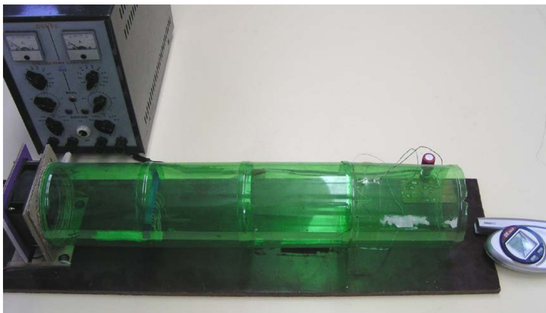
Obr. 1 Stend pro měření proudění s možností nastavování úhlu i délky (celkové uspořádání měření).
