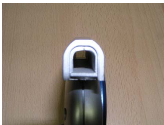
Obr. 1.4 Detailní pohled na bezkontaktní měření rychlosti proudění – ultrazvukový princip
