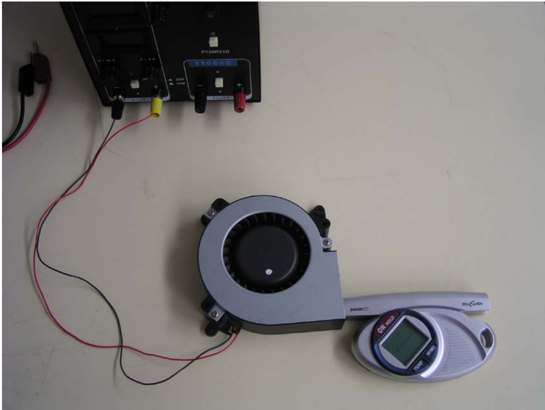
Obr. 1.3 Měření pro rychlost proudění vzduchu za ventilátorem (celkové uspořádání měření)
