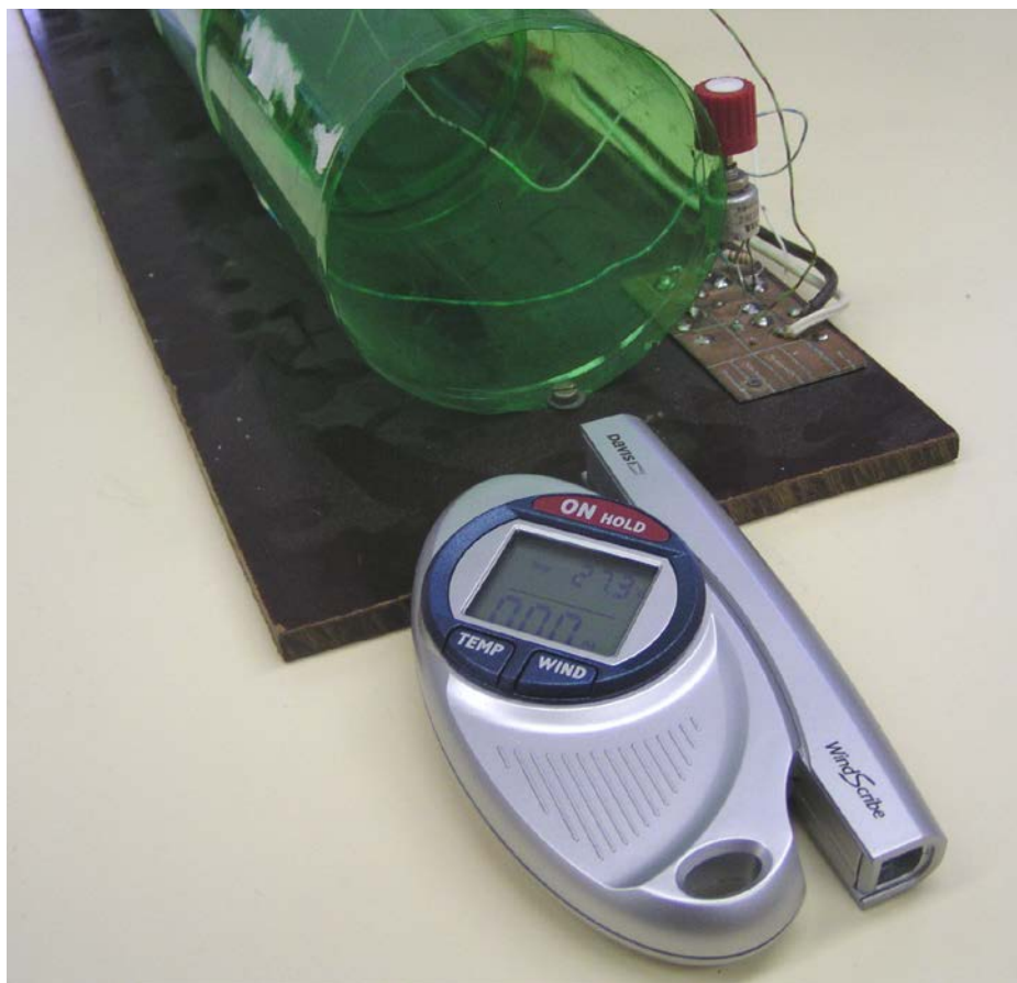
Obr. 1.1 Měření u výstupu pomocí anemometrického přístroje
