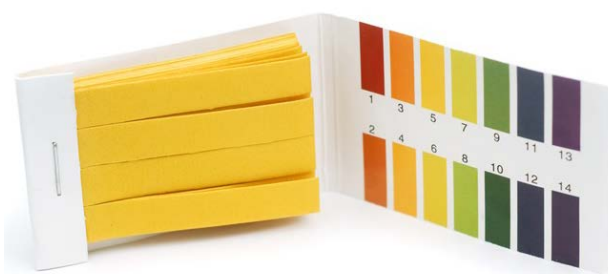
Obr. 1 – Papírové indikátory s rozlišovací barevnou stupnicí
