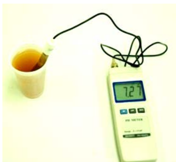
obr.1.2 Digitální pH metr při měření kyselosti kapaliny (čaj)
