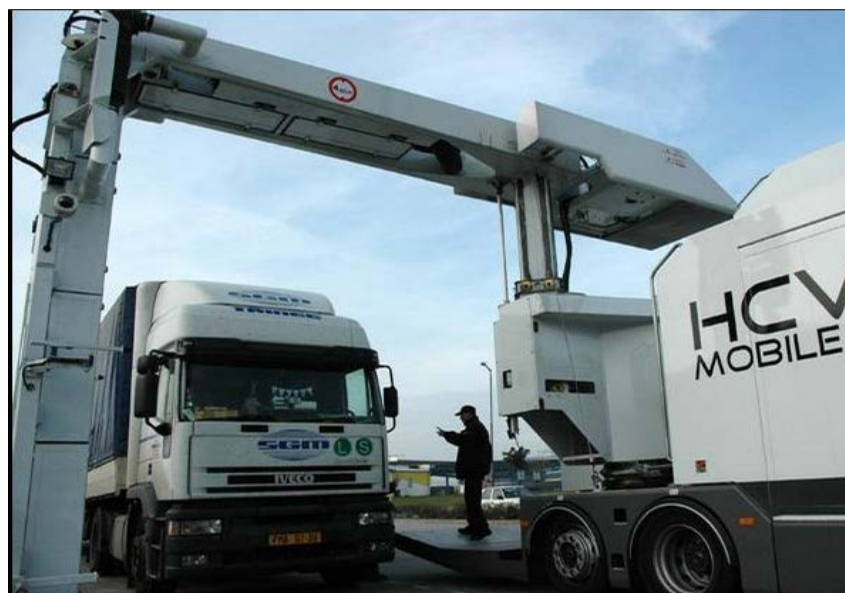
Obr. 1.8 – Moderní mobilní rentgenový přístroj pro skenování nákladu vozidel [12]
