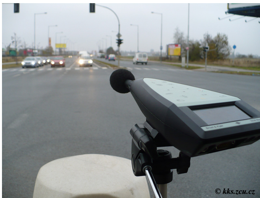
Obr. 1.1 Příklad měření hlukoměrem s analýzou a záznamem dat z měření
