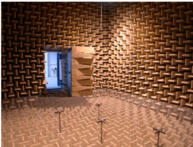
Obr. 1.2 Uspořádání vnitřní části bezodrazové komory [10]
