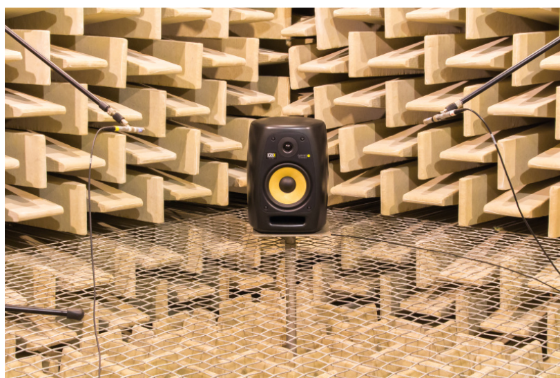
Obr. 1.3 Detailní uspořádání měření v bezodrazové komorě [10]
