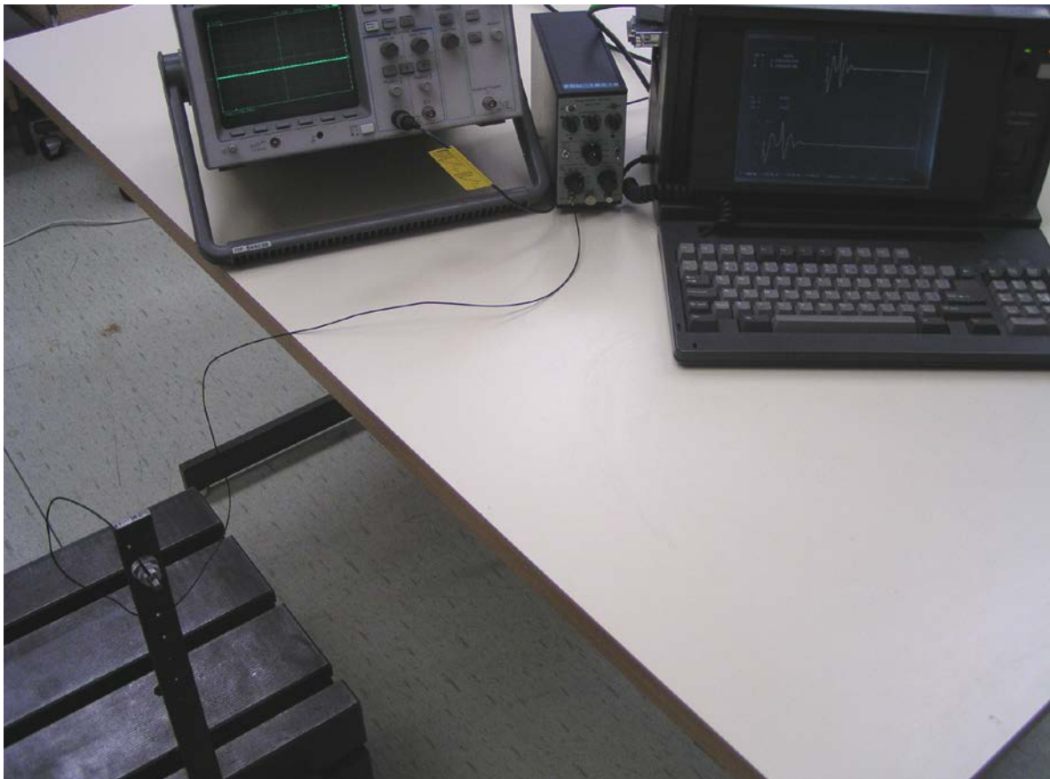
Obr. 1 - Zkušební sestava pro analýzu vlastních kmitů (celkové uspořádání měření)
