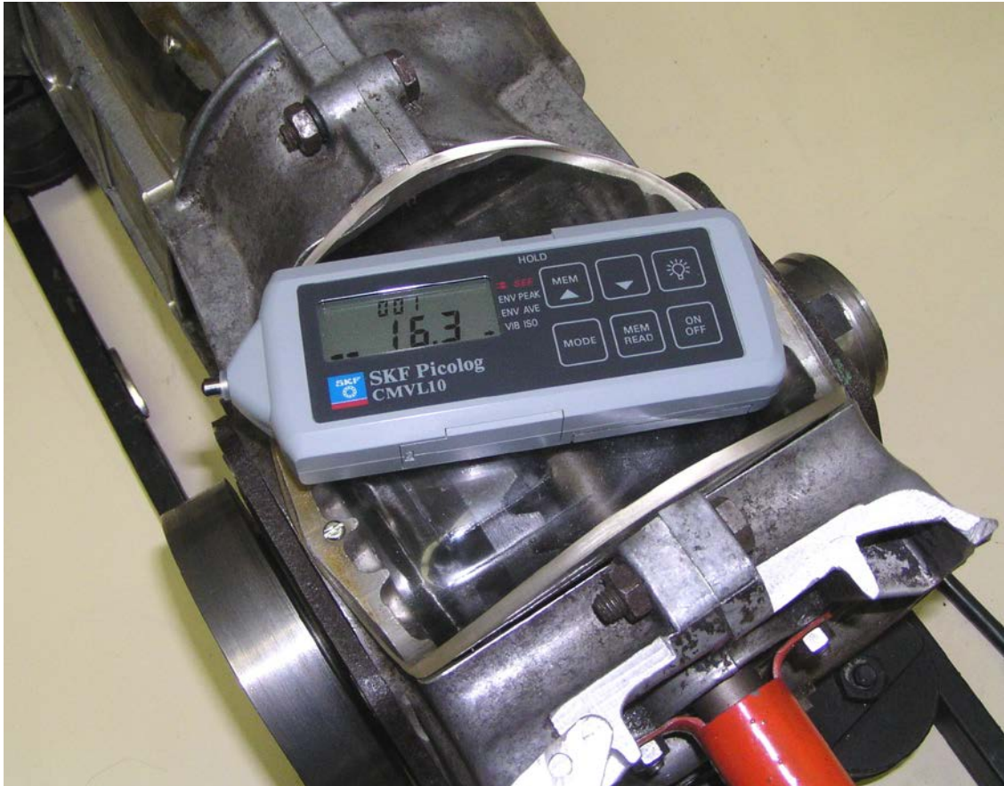
Obr. 3 - Měřicí přístroj a testovaná ložiska v převodové ústrojí
