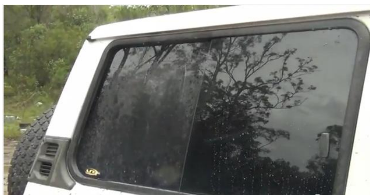
Obrázek 19 - Zrcátko - levá polovina je normální, zatímco na pravou polovinu je nanесena hydrofilní vrstva
