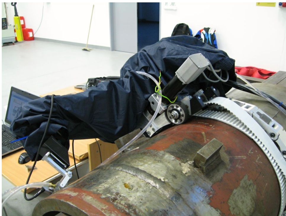
Obrázek 1: Prototyp manipulátoru Sáva na reálné zkušební tělese
