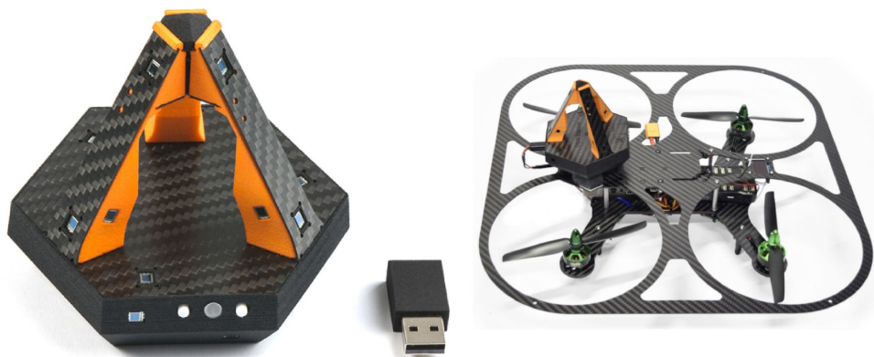
Obrázek 2: Systém Otus Tracker (pevně spojen s pohybujícím se objektem)
