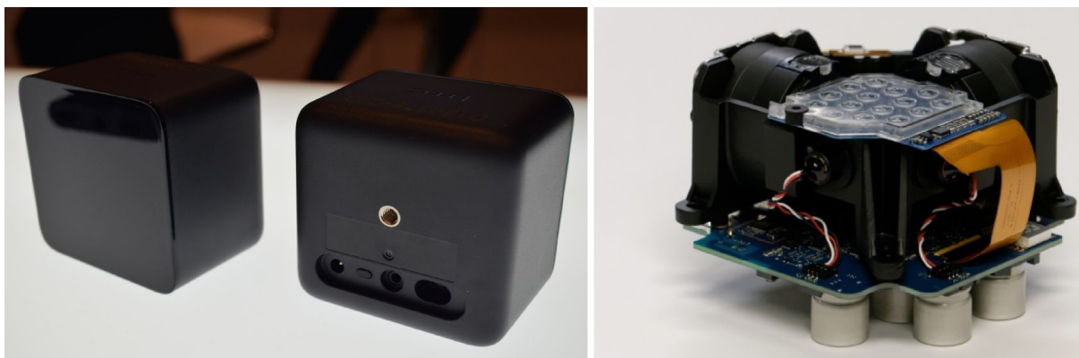
Obrázek 3: Měřicí základny HTC Vive
