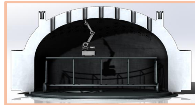
Robot pro NDT nátrubků víka reaktorové nádoby z vnitřního povrchu (Škoda JS, a.s.)
