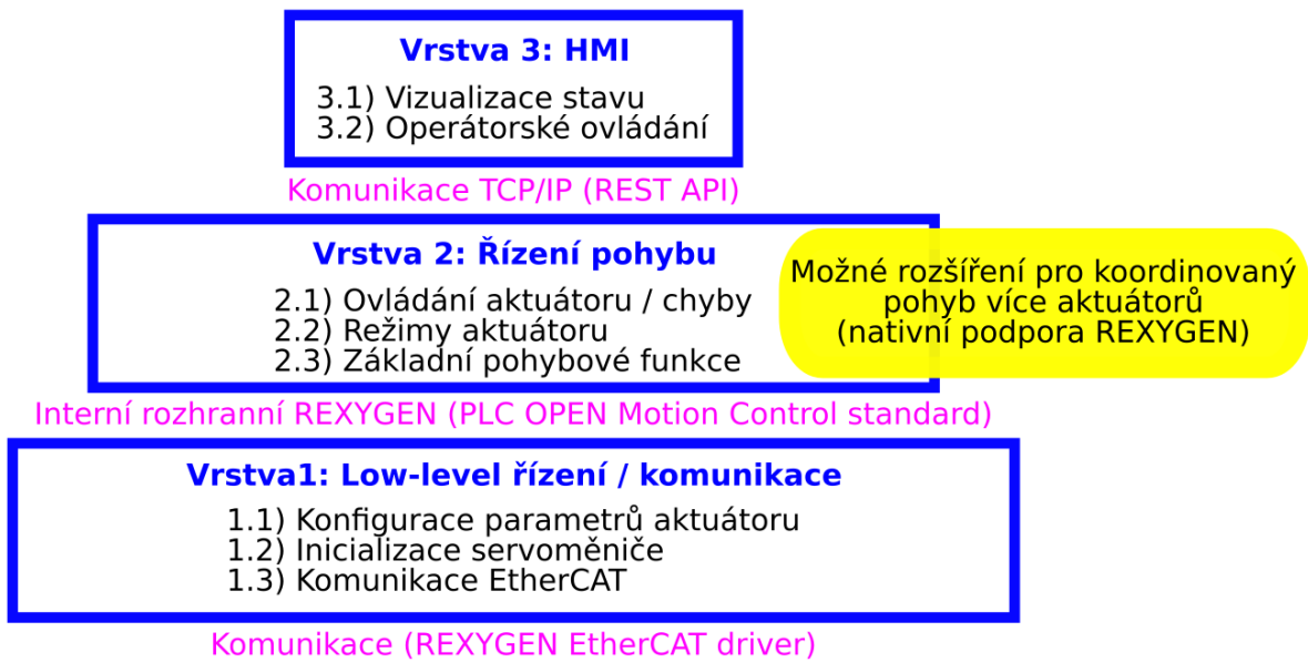
Obrázek 5: Vrstvy řídicího systému kompaktního aktuátoru
