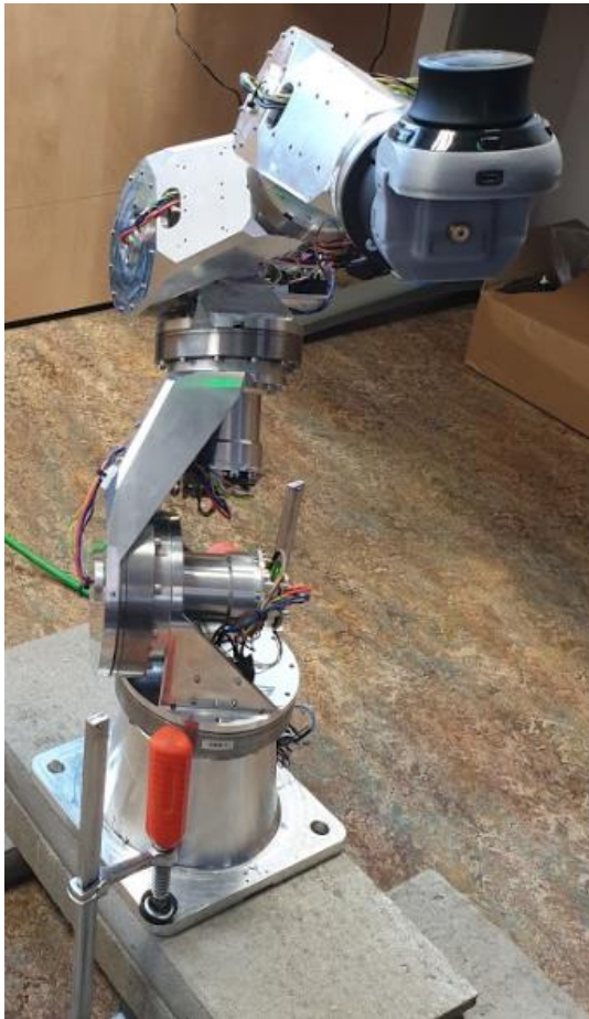
Foto 2: Detail 3D myši pro navádění koncového efektoru (hand-guidance)
