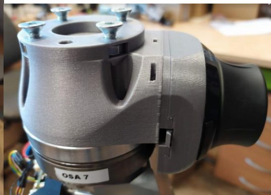
Foto 3: Reduktor příruby robotu - kompatibilita s přírubami robotů Universal Robots
