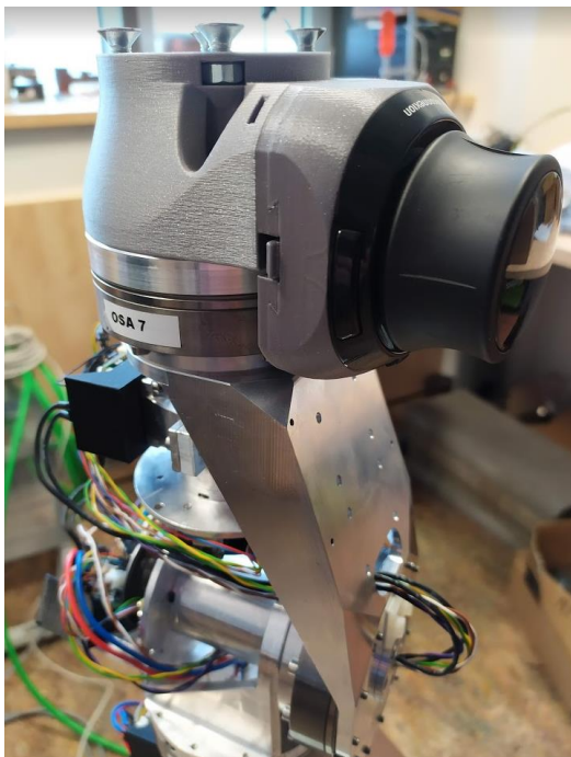
Foto 3: Reduktor příruby robotu - kompatibilita s přírubami robotů Universal Robots
