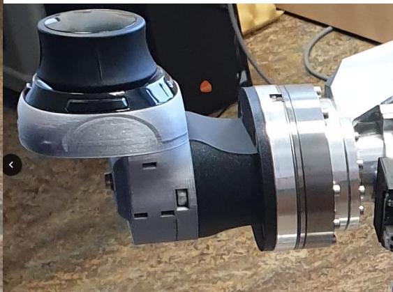
Foto 2: Detail 3D myši pro navádění koncového efektoru (hand-guidance)
