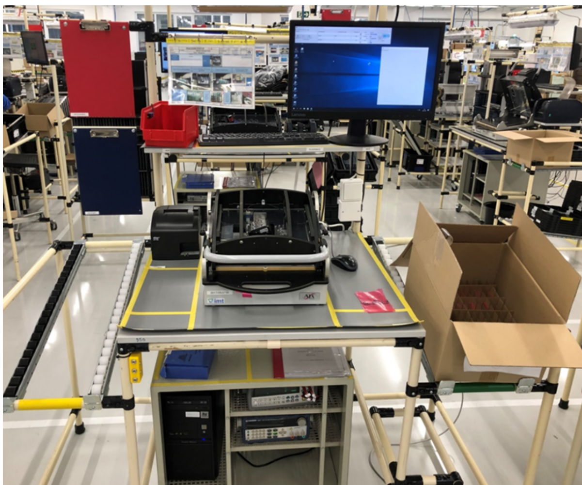
Obrázek 1: Příklad ručního stanoviště funkčních testů FCT
