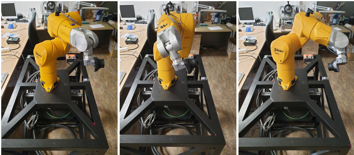
Obrázek 1: Příklad lokalizace umístění robotu zaměřením rohů pracovní desky laserovým dálkoměrem na koncovém efektoru robotu
