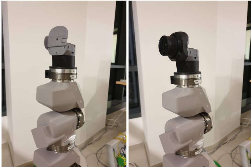
Obrázek 8: Koncový efektor prototypu robotu vyvinutého v rámci projektu FV10044 s osazenou konzolí pro připojení 3D
