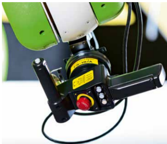
Obrázek 4: Senzor síly Fanuc FS-15iA s přídatným HW pro ruční navádění robotu
