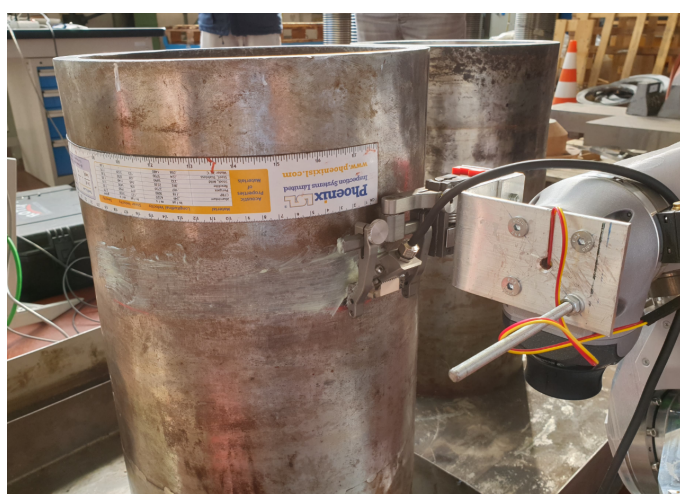
Obrázek 2: Reálné testy s původním robotem na hale ÚJV (princip identifikace kruhového svaru)
