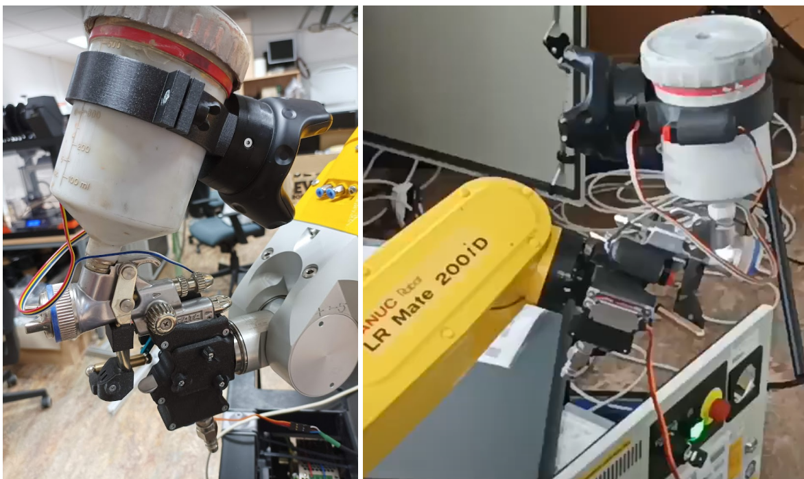
Obrázek 4: Konzole k přichycení pracovního nástroje k robotu instalovaná společně s trekovacím zařízením a vlastním nástrojem (stříkácí pistolí) na robotech Staubli TX40 (vlevo) a Fanuc LR Mate200iD
