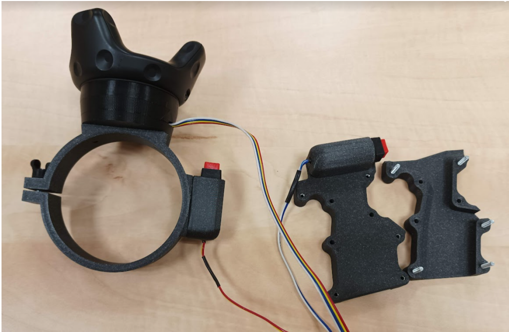
Obrázek 1: Konzole trekovacího zařízení s funkčním tlačítkem vzdáleného ovládání (vlevo), konzole k přichycení pracovního nástroje (stříkací pistole) s tlačítkem snímání stisku spouště.
