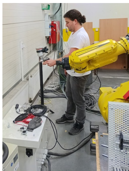
Obrázek 1: Osazené trekovací zařízení na robotu Fanuc M800iA60 (vlevo), testování trekování pohybu operátora
