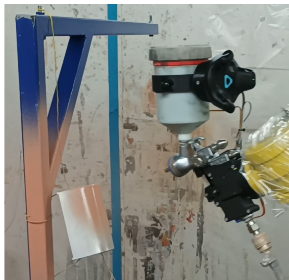
Obrázek 11: Replikace pohybu robotem a automatické lakování dílu
