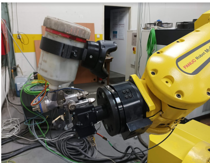
Obrázek 1: Osazené trekovací zařízení na robotu Fanuc M800iA60 (vlevo), testování trekování pohybu operátora
