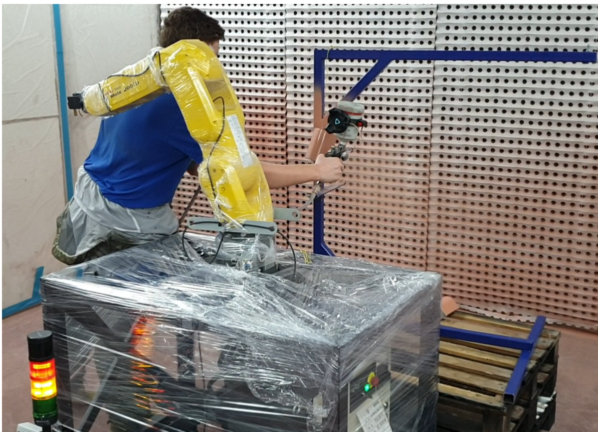
Obrázek 10: Lakýrník při učení pohybu lakovací pistole během reálného procesu lakování
