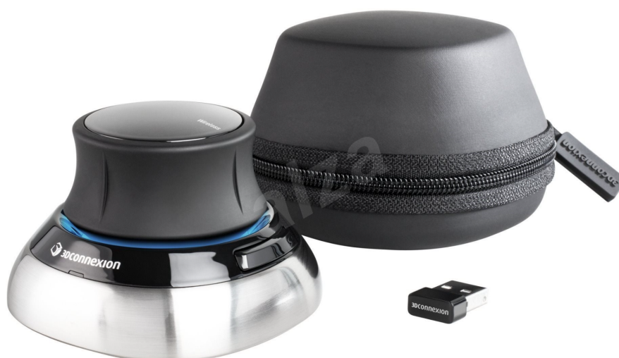
Obrázek 7: Senzor 3D myši, který byl integrován s robotem UR5
