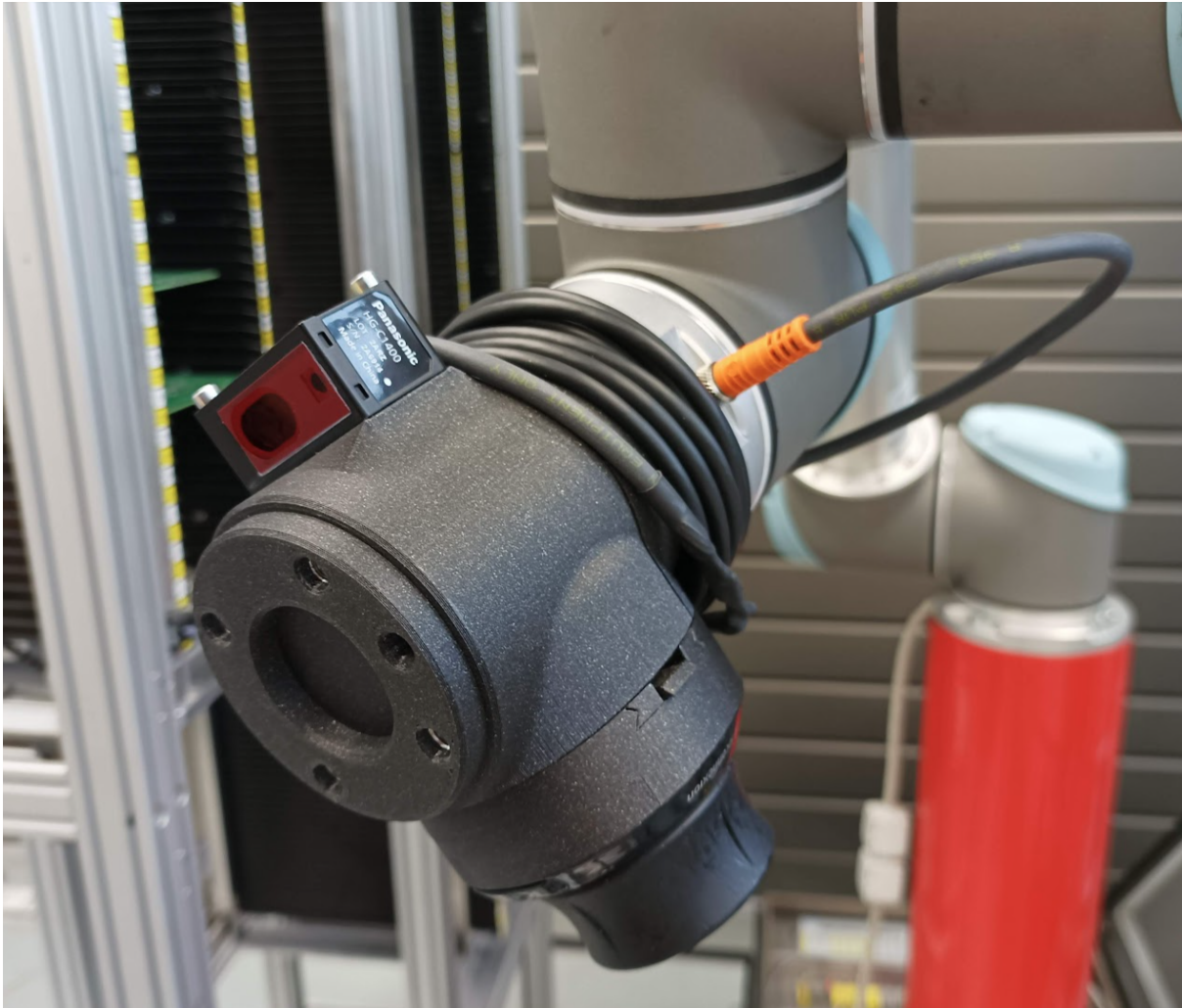
Obrázek 2: Laserový dálkoměr na a senzor 3D myši na koncovém efektoru robotu
