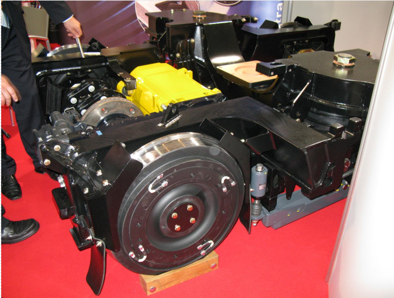
Brzda v tramvajovém podvozku- kotoučová, kolejnicová
