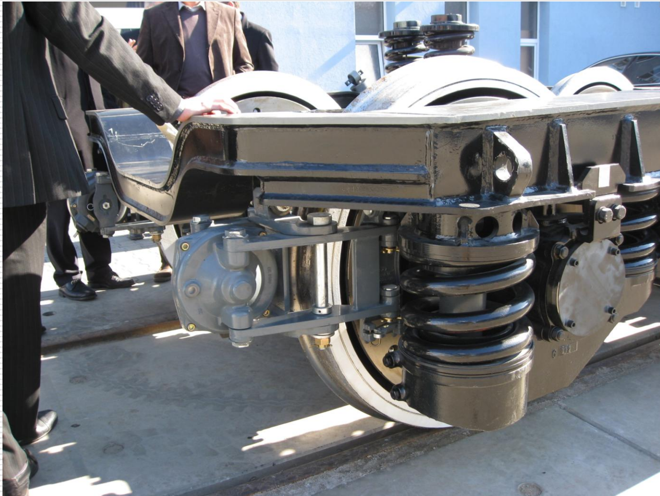
Kotoučová brzda v kole (disková brzda)
