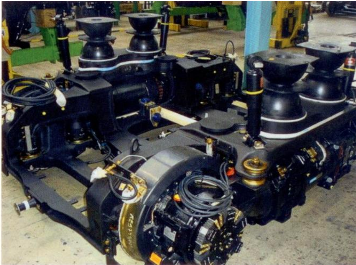
Bild 4: Triebdrehgestell Combino Plus Budapest; im Vordergrund rechts ist der längsliegende voll abgefederte Antrieb dieser Drehgestellseite zu erkennen.
