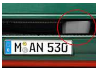
Obr. 5-3: Umístění radaru na tahači MAN [21]
