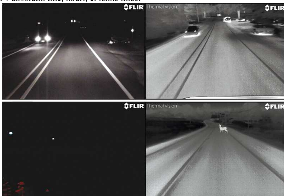
Obr. 4-9: Porovnání obrazu z CCD a IR kamery [25]
