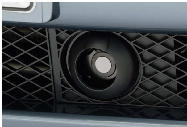
Obr. 4-11: Kamera PathFind IR a její umístění v mřížce pod značkou automobilu [26]
