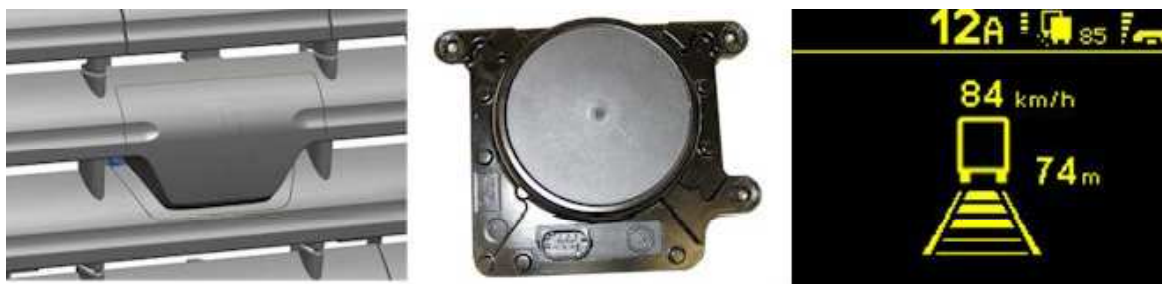
Obr. 5-1: Umístění radaru, radar a signalizace ACC u DAFu [18]
