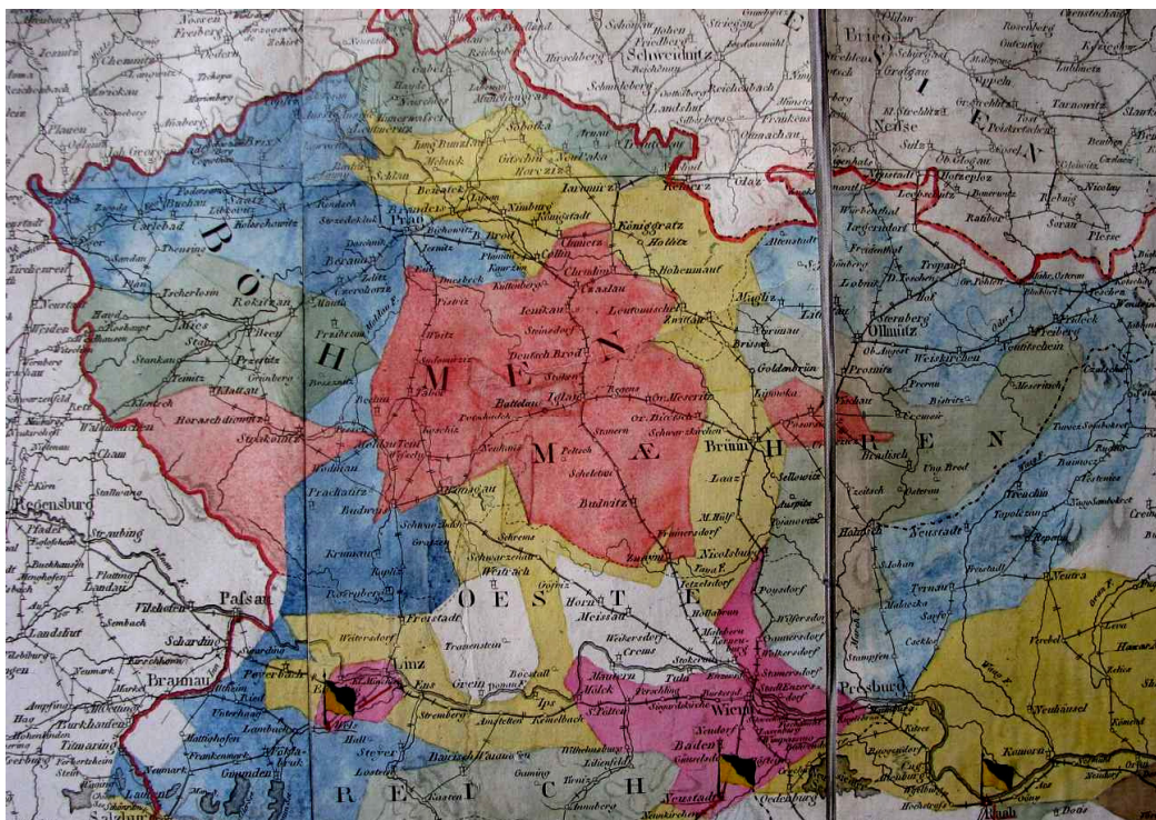
Obr. 8 Vojenská triangulace vybudovaná na tehdejší území Čech, Moravy a Slezska v letech 1806 – 1811 a délkové základny u Welsu (Wells), Vídeňského Nového Města (Wiener Neustadt) a u Rábu (Raab) – zleva, vyznačené žlutočernými praporky. Území triangulované roku 1806 je znázorněno růžově, 1807 žlutě, 1808 modře, 1810 tmavě zeleně, 1811 červeně (Arbeiten des k.k. Generalquartiermeisterstabs... 1850).
