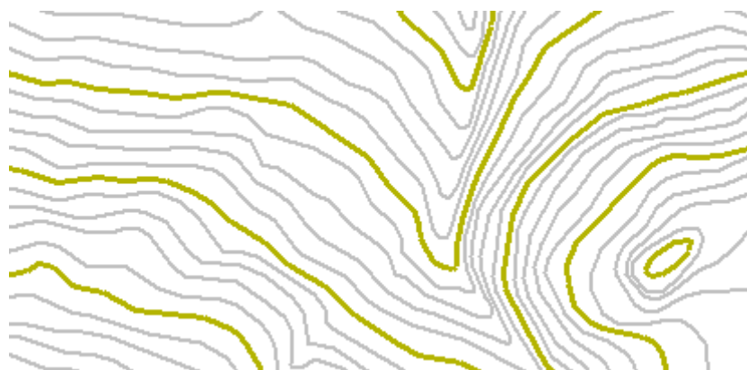
Obr. 74 Výřez výškopisu DMR ZABAGED (3D vrstevnice, i = 5 m) poskytnutého Zeměměřickým úřadem v Praze.
