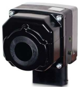
Obr. 6-4: Kamera PathFind IR a její umístění v mřížce pod značkou automobilu
