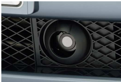
Obr. 6-4: Kamera PathFind IR a její umístění v mřížce pod značkou automobilu
