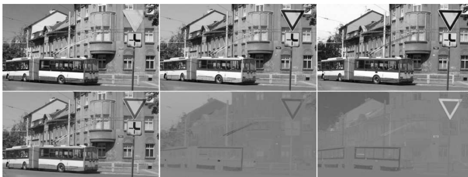
Obr. 4-7: Horní řada- obraz ve vrstvách RGB, Dolní řada obraz v Y,Cb,Cr
