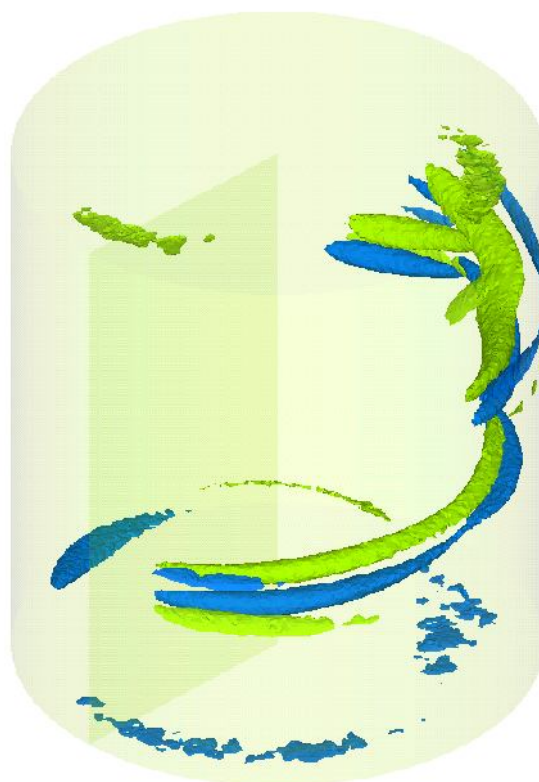
Obrázek 4.12: Ukázka vírových struktur identifikovaných pomocí kritéria Q v proudu tekutiny
