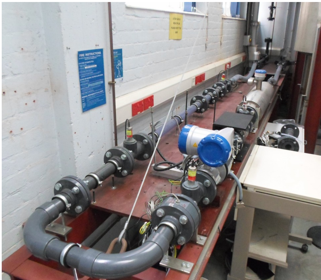
Obr. 16: Experimentální zařízení pro měření proudění vody s pískem
