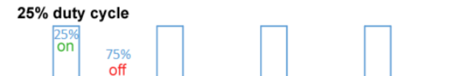
Obrázek 1: Konkrétní případ pulzně-šířkové modulace, zde jako příklad, jak docílit menšího svitu LED; výřez převzat z https://en.wikipedia.org/wiki/Pulse-width_modulation
